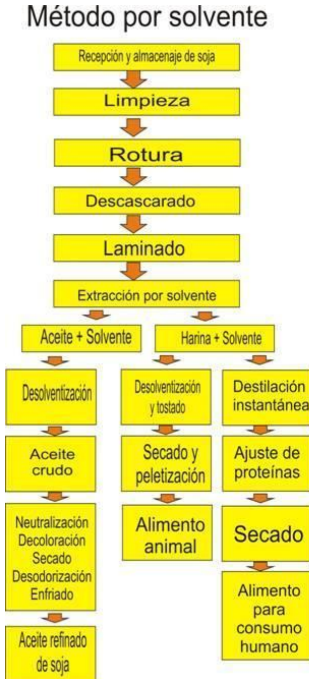
DIAGRAMA: Proceso de extracción de aceites y harinas de soja por solvente
